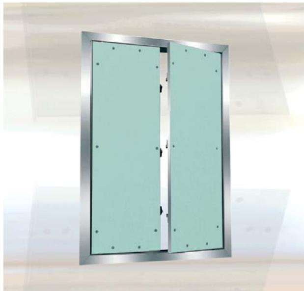
Trapa este realizată din profile de aluminiu cu inserție de gips-carton hidrofug de 12,5 mm, 15 mm sau 25 mm și cu două sau mai multe sisteme de închidere prin apăsare. Cadrele trapei sunt realizate din patru profile solid sudate printr-o procedură specială.
